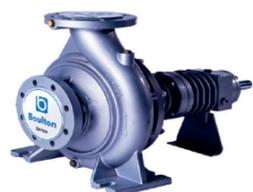
Bomba centrífuga para óleo térmico ou óleo industrial de baixa viscosidade sem partículas abrasivas. Refrigerada a ar, cumpre em dimensões com a **norma EN 733**. Com um design modular, o conjunto completo do rotor, impulsor e a tampa da carcaça podem ser removidos sem tirar a cobertura da espiral do sistema de condutas. Todos os impulsores estão equilibrados de forma estática e dinâmica, em **conformidade com a ISO 1940** ponto 6.3. empanques mecânicos concebidos para altas temperaturas.
